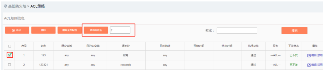
图 错误!文档中没有指定样式的文字。-15 ACL 策略规则优先级调整
