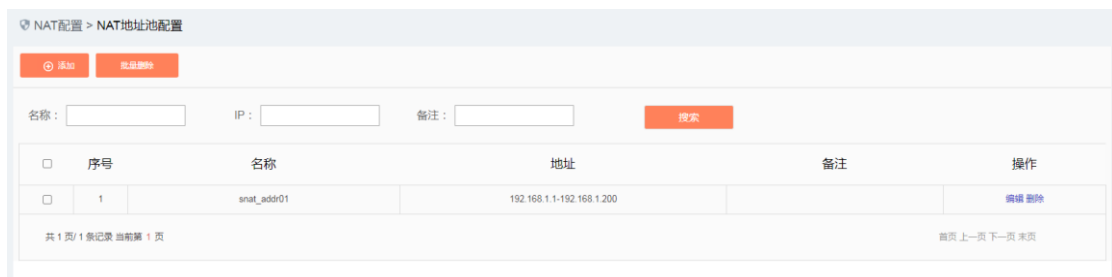
图 错误!文档中没有指定样式的文字。-42 NAT 地址池配置页面
