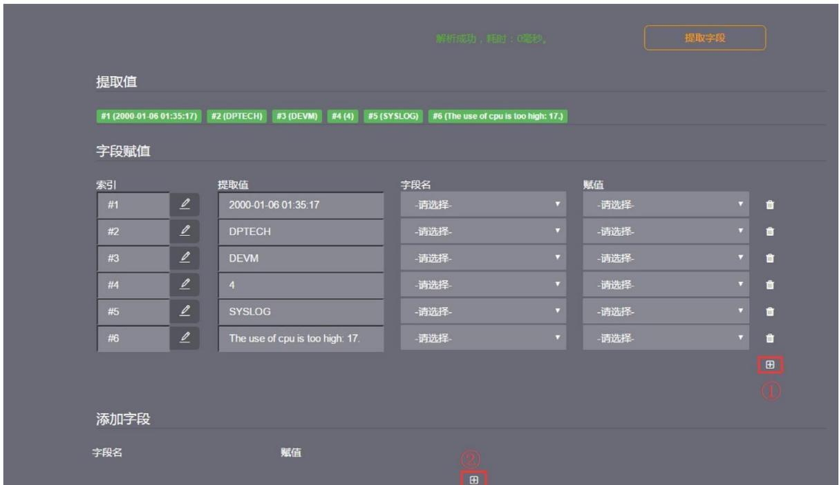
其中[提取值]和[字段赋值]列出正则表达式当前能提取出的字段，接下来用户就可以自行选择每个提取值所对应的字段名称、时间格式以及映射关系。如果提取值需要多次使用，或者多个提取值需要拼接使用，请点击上图中 1 号位置的【+】按钮，此操作会在当前[字段赋值]列表最下方新增一行，用户需要手动输入索引值，如#3 或者#3#4（多个
