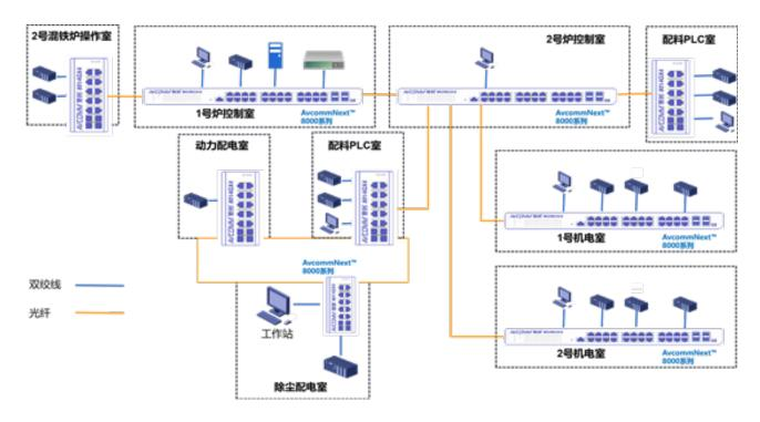
钢铁厂的高炉和熔炉由于处于长期无间断工作状态,工作环境苛刻,经常接触铁水、腐蚀性化学物质,周围的电磁干扰也十分大。因此,系统的可靠性和冗余性成为了缩短宕机时间的关键因素。为了实现对钢厂的全面监控,恩创选用 AVCOMM 系列工业级以太网交换机。该产品体积小,端口集成度高,具备即插即用功能,成本低。采用可靠的光纤冗余环网来连接所有高炉,该冗余环以太环网具备断线后 20ms 内快速恢复的能力。工业防火墙结合工业控制网络的特点,对工业控制数据包进行过滤,主要手段有白名单机制、工业协议深度解析等,保护网络安全。此外,交换机易于配置和管理,适用于苛刻的工业环境,网络结构如下图所示。
