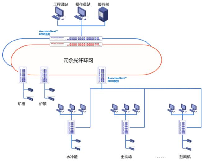
使用工业以太网交换机组建的系统,是用于升级改造钢厂内部设备提供的自动化系统。使用恩创 AVCOMM 系列全管理工业交换机,该产品具备全千兆的交换能力,先进的网络链路冗余协议 A-Ring 与 A-Link,确保通信设备与链路的稳定可靠与链路自愈。工业以太网交换机之间通过光纤采用星型拓扑结构和环形拓扑结构组合连接,恩创工业交换机各端口拥有自适应能力,提供 Web、CLI 和 SNMP 三种管理方式,支持 Telnet 和 console 登录。可通过CLI 命令行对工业交换机进行管理设置,可以简化工程师的操作,当有特殊需求时,这些特点为企业不间断生产提供安全可靠的保障。
